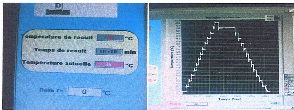
Figure 3. 23: Interface de pilotage de la température.
