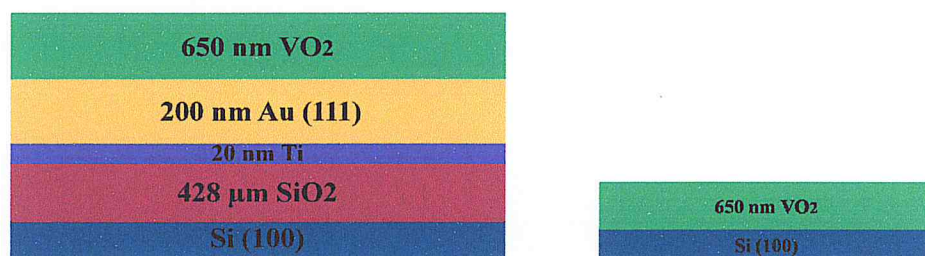
Figure 4. 2: Schéma résumant la structure des couches déposées.
