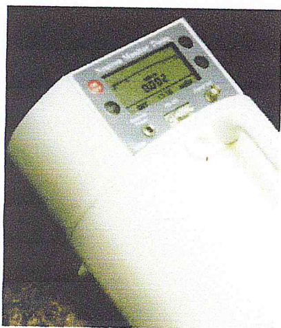
Figure I.13 : Moniteur de neutrons Studvick à base de \text{BF}_3 .
