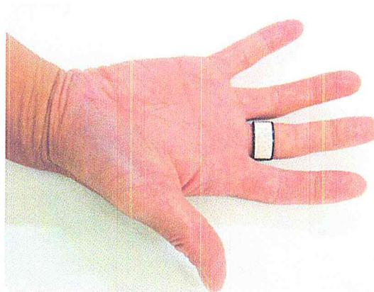
**Figure IV.14 :** Dosimètre d'extrémités [CCS12].
