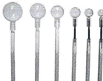
**Figure III.7 :** Jeu de sphères creuses de diamètre croissant.
