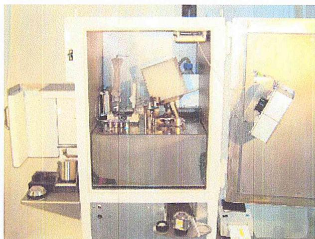
Figure IV.7 : Automate de préparation des seringues de [18F]-FDG.
