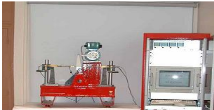
Figure 2.16: Essai de fatigue sur éprouvettes trapézoïdales [21].
