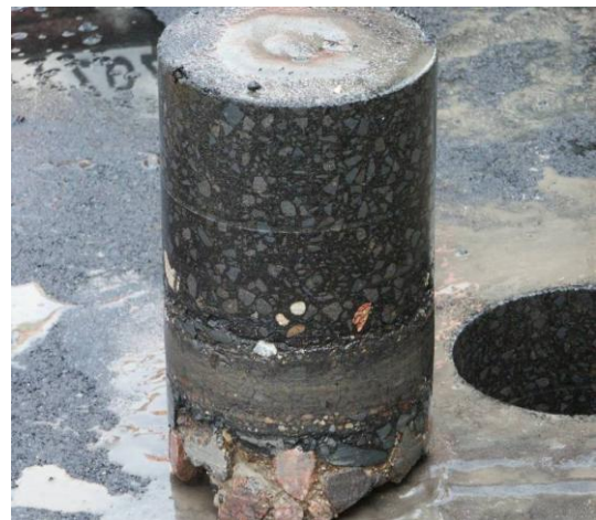
Figure 2.2 : Prélèvement sur chantier du matériau Bitumineux [12].
