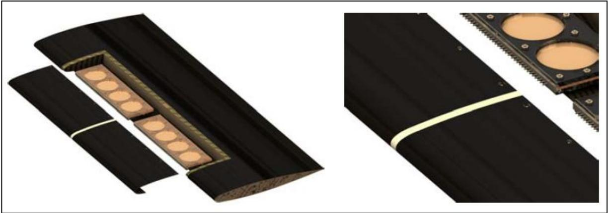
**Figure 1.6** : Prototype d'un actionneur à microjets synthétiques. (ONERA D)
