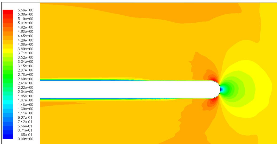
**Figure 5.22:** contours de vitesse calculé avec décharge a  $U_0 = 4\text{m/s}$
