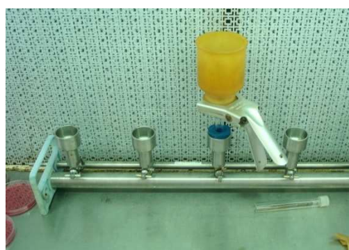
Rampe de filtration à 6 postes
