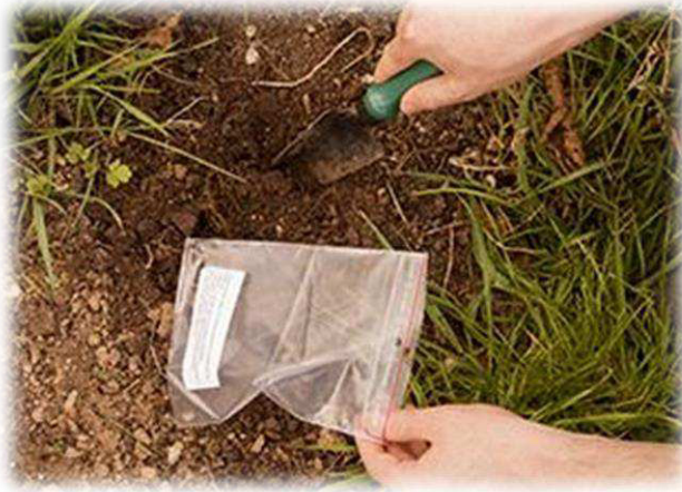
Figure III.7 : Matériel utilisé pour le prélèvement du sol
