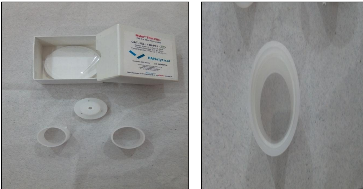
Figure III.8 : Feuille de mylar +les tubes (à gauche) porte-échantillon (à droite)
