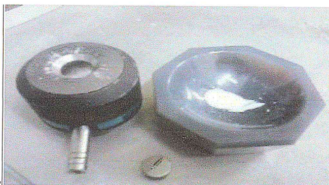
Figure II.9 : Mortier en agate et le moule utilisé
