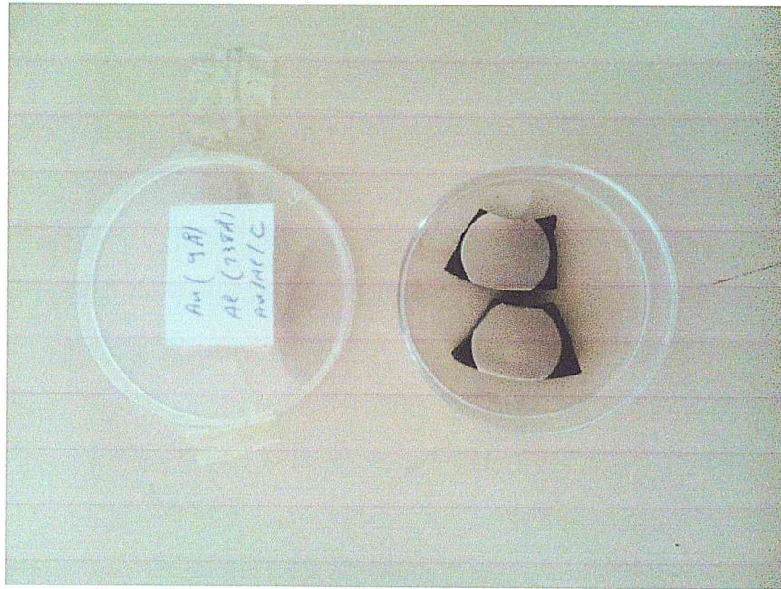
Figure 08 Dépôt d'or d'épaisseur 9 Å sur une couche d'aluminium d'épaisseur 238 Å sur un substrat de charbon
