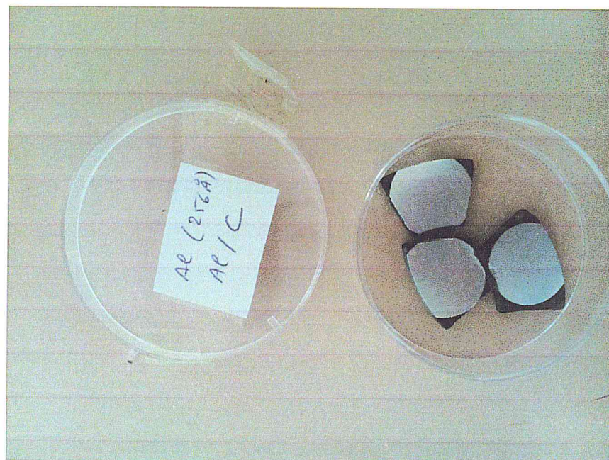
Figure 07 Dépôt d'aluminium d'épaisseur 256 Å sur un substrat de charbon
