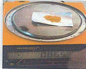
Figure II.12. La masse de la charge  $\text{Y}_{0,695}\text{Gd}_{0,295}\text{Eu}_{0,01}\text{VO}_4$
