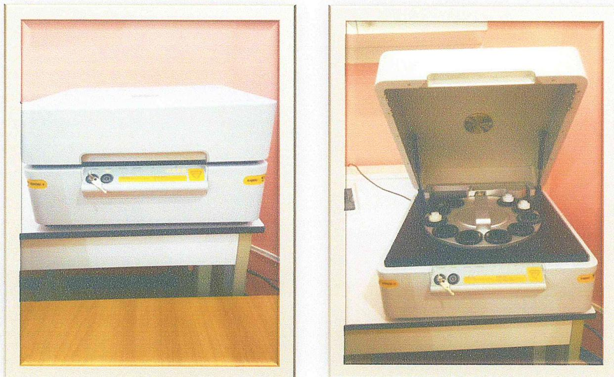
**Photo III.8 :** Dispositif de la fluorescence des rayons X(PANalytical ) au niveau de laboratoire FUNDALP.
