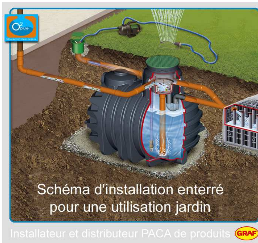
figure: Exemple de brique à eau récupératrice d'eau de pluie, enterrée pour une utilisation jardin.
