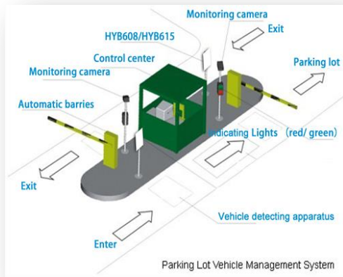
figure 3.43: schéma du fonctionnement des barrières automatiques.
