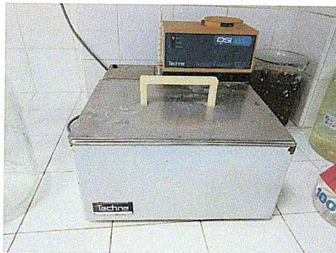
**Figure 3.4.**Bain de développement chimique
