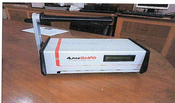
**Figure 4.5.** Moniteur de radon type Alpha GUARD
