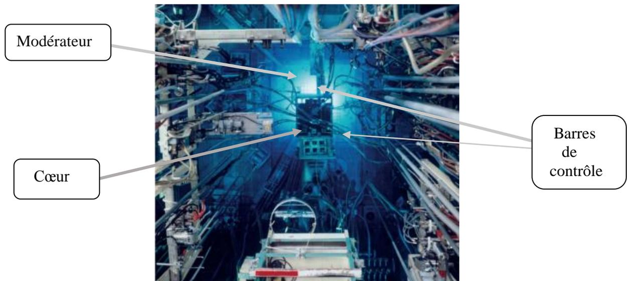
Fig. 1.1 : Configurations montrant un cœur d'un réacteur nucléaire de recherche.
