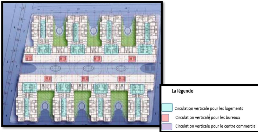
Figure47 : plan RDC et la circulation verticale
