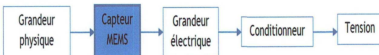
Figure II.6: Chaîne de mesure et d'information [29].
