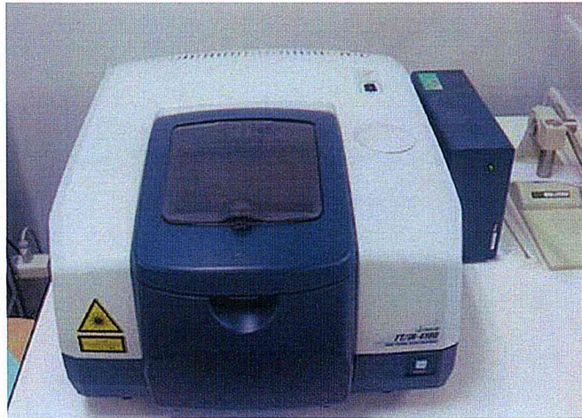
Figure II.11 : Photo de Spectroscopie Infrarouge à Transformée de Fourier utilisé.
