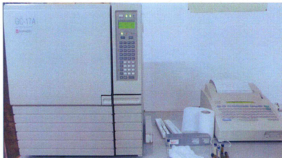
Figure II.10 : L'appareil de CPG utilisé lors de la détermination de concentration de méthanol dans le compartiment dilué.
