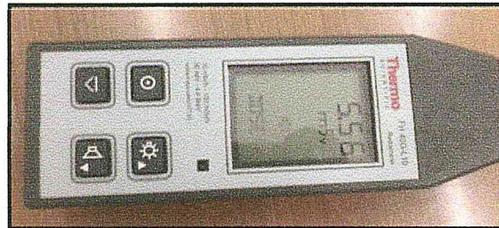
Figure III.3 : Le radiamètre de type FH40 utilisé pour la mesure de \dot{H}^*(10) .
