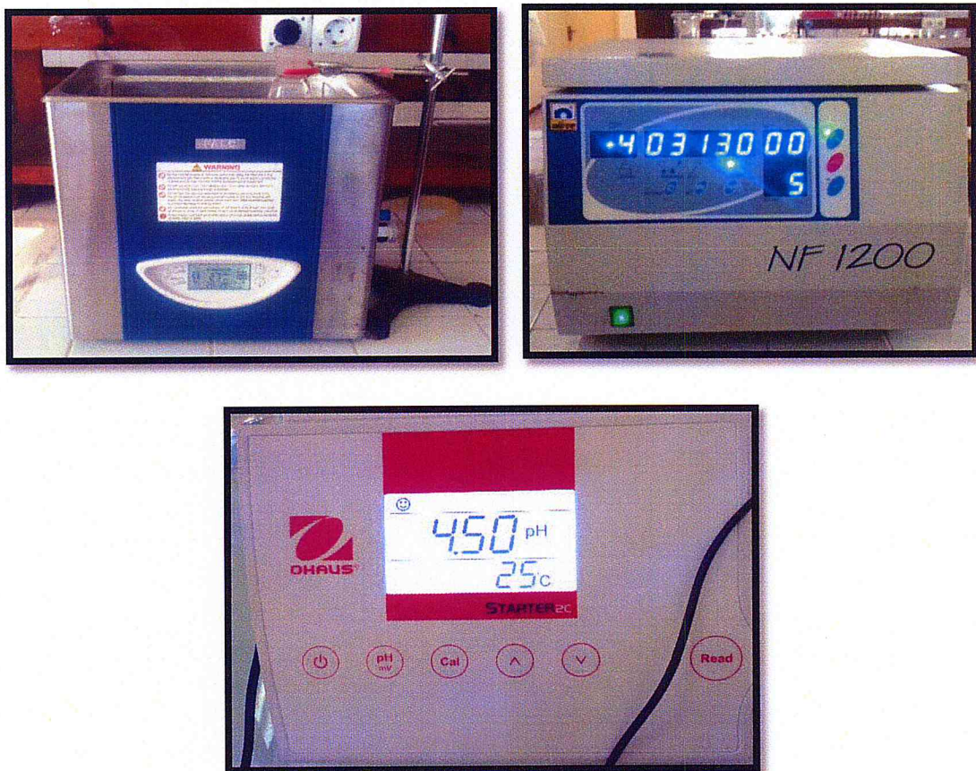
Figure IV.1 : Bain à ultrasons (en haut à gauche), Ultracentrifugeuse (en haut à droite), pH mètre (en bas)
