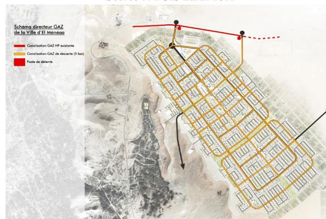
Figure 65 : réseau de GAZ dans la ville nouvelle d'el-ménéa
