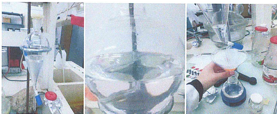
Figure 4 : Extraction liquide-liquide de l'HE de la phase aqueuse
