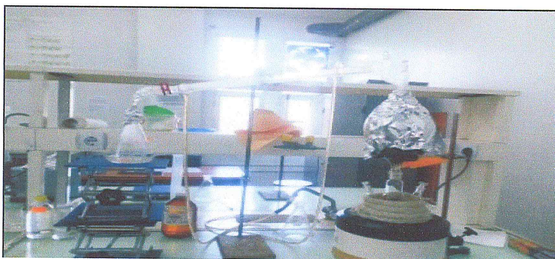
Figure 3 : Dispositif expérimental d'entraînement à la vapeur d'eau de l'HE
