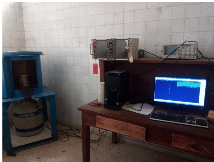
Figure. II. 9: Installation de la chaîne de mesure de spectrométrie gamma (CRND).
