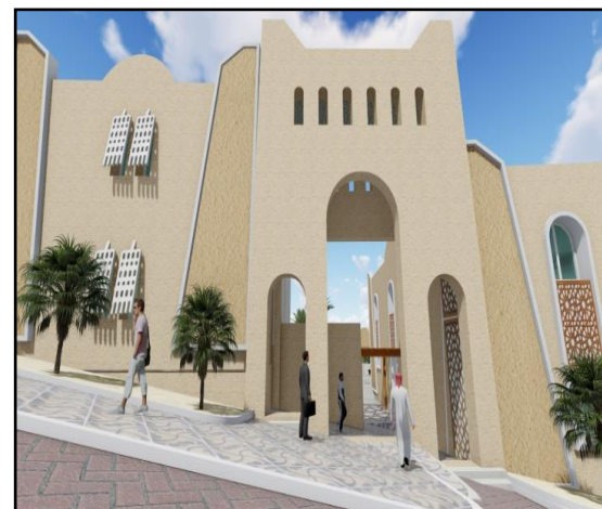
Les fenêtres sont protégées par les moucharabiehs Source : auteur.
