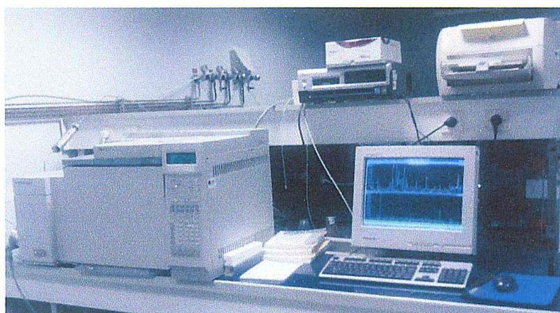
Figure 5 : Appareil de chromatographie en phase gazeuse couplé à la spectroscopie de masse
