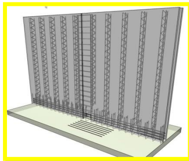
Figure 158 : voile de contreventement en béton. source: https://notech.franceserv.com/contreventements.html
