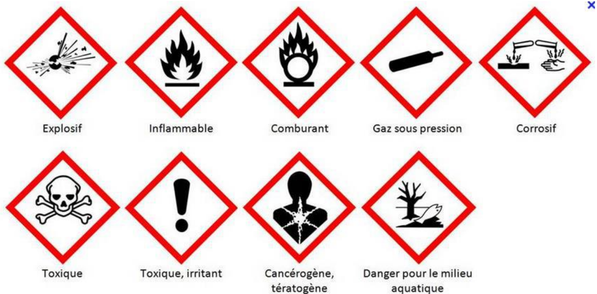
Fig. 3-14 : image montrant les pictogrammes de sécurité qui peuvent alerter sur l'existence d'un danger éventuel
