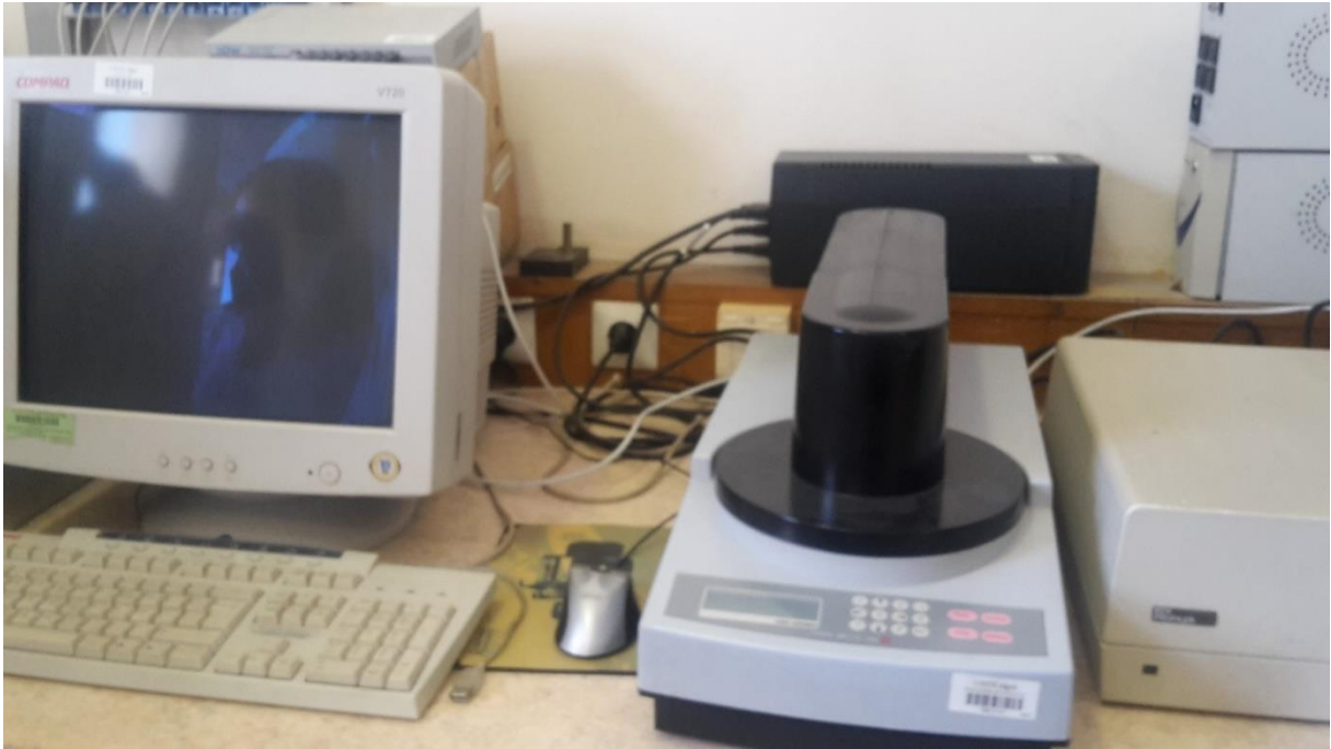
Figure III.5: dispositif de mesure de la conductivité de quatre pointes.
