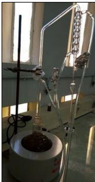
Figure 2.3 : Montage de l'hydrodistillation (type Clevenger).
