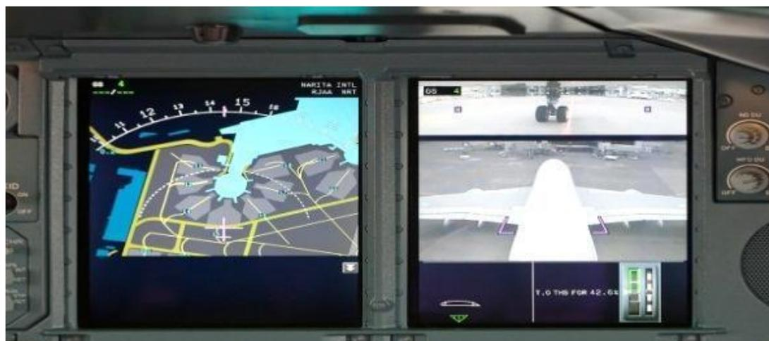
Figure 4.6 : Vues des caméras externes dans le cockpit de l'A380.
