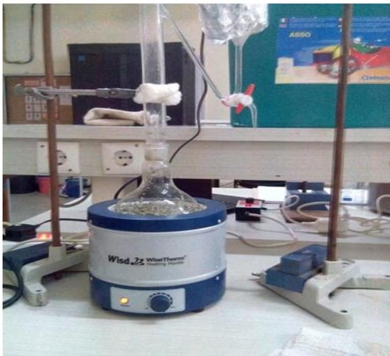
Figure 6: Dispositif d'hydrodistillation type Clevenger (originale)
