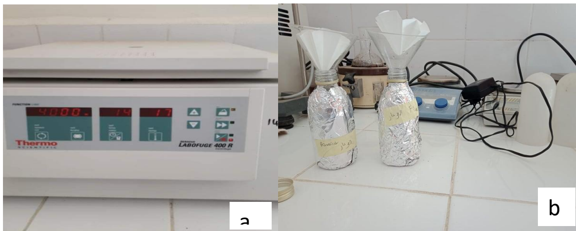
Figure 35 : centrifugation et filtration des extraits aqueux (Original,2020). a : centrifugeuse utilisée type «LABOFUGE 400R» ;b : Filtration sur papiers filtre N°1
