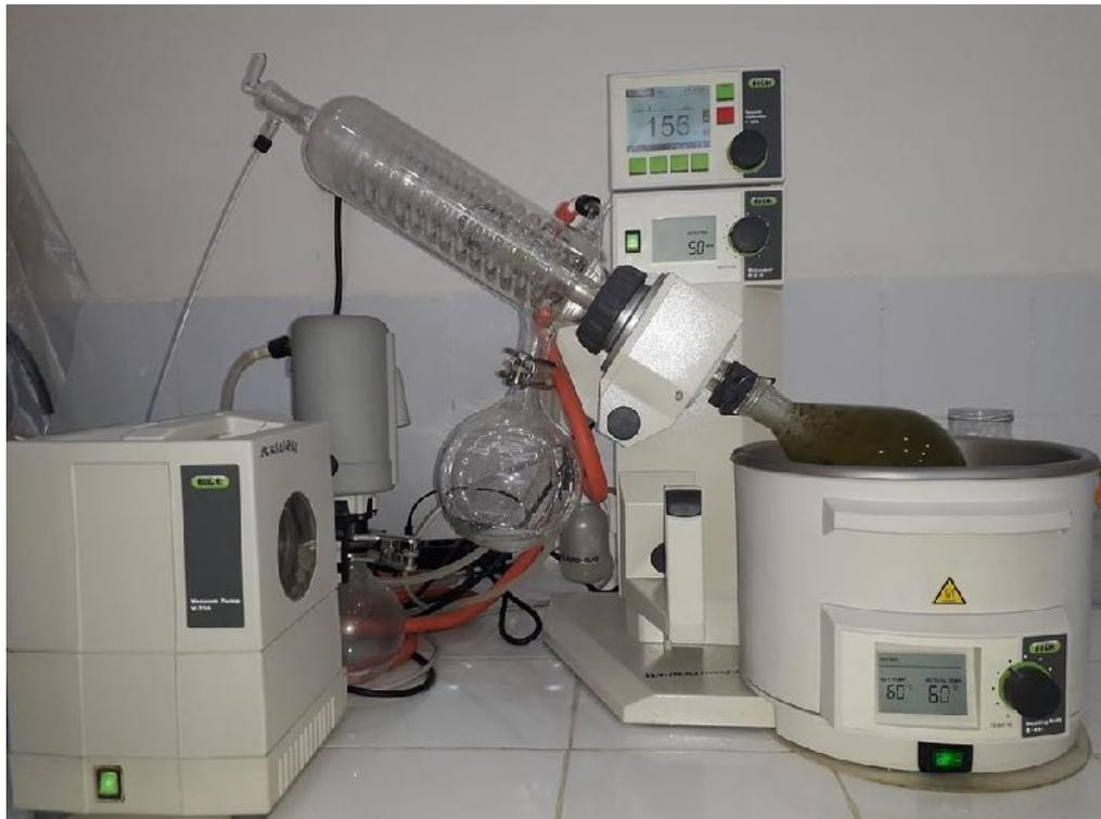
**Figure 8 : appareillage de rotavapeur**
