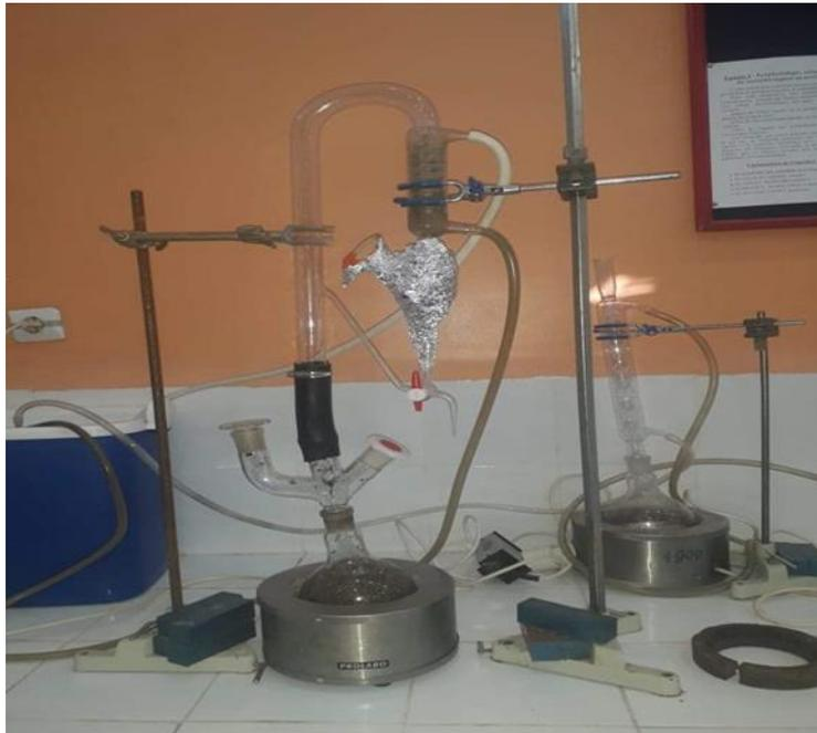
Figure n°15 : Appareil de Clivenger (Originale, 2020).
