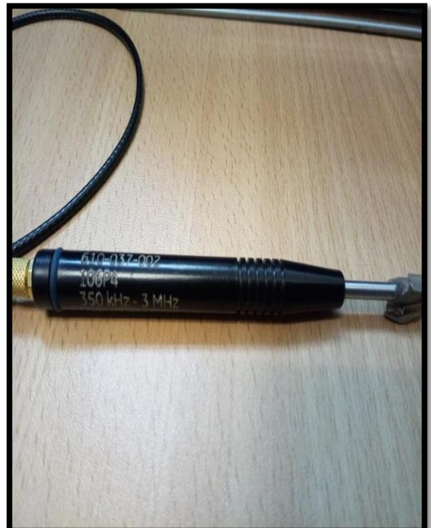
Figure III.2. Sonde différentielle
