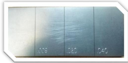
Figure III.7.Dimensions caractéristiques du défaut en inch
