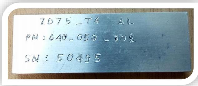
Fig.III.6.Plaque d'aluminium 7075-t6
