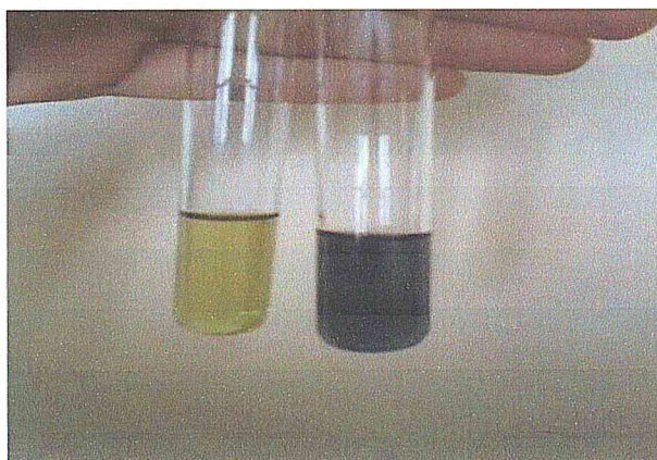
Figure 33: Photographies représentatives du changement de couleur de l'acide gallique au dosage des PPT par la méthode de Follin Ciocalteu
