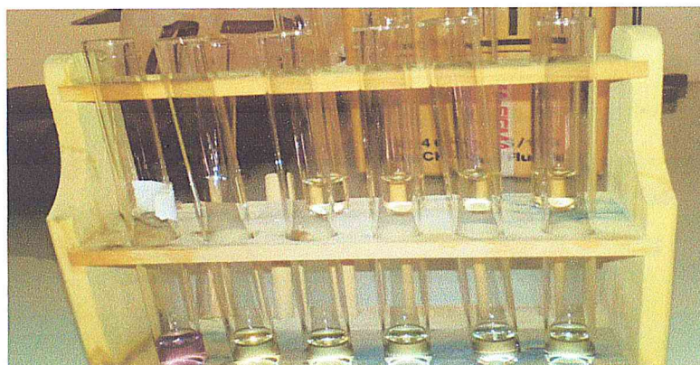
Figure 34 : Photographies représentatives du changement de couleur de l'acide ascorbique au test de piégeage du radical libre DPPH
