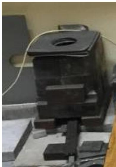
Figure IV.4 : Source d'irradiation bêta.
