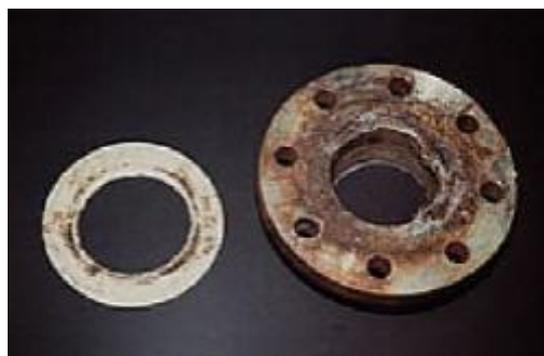
**Figure I.11:** Corrosion cavernueuse d'un acier allié sous un joint [42]
