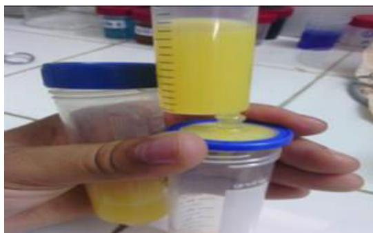
Figure 16: Filtration de plasma jaune d'œuf(8).
