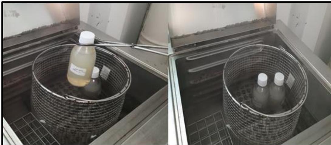
**Figure 18** : dissolution de gélose dans l'autoclave
