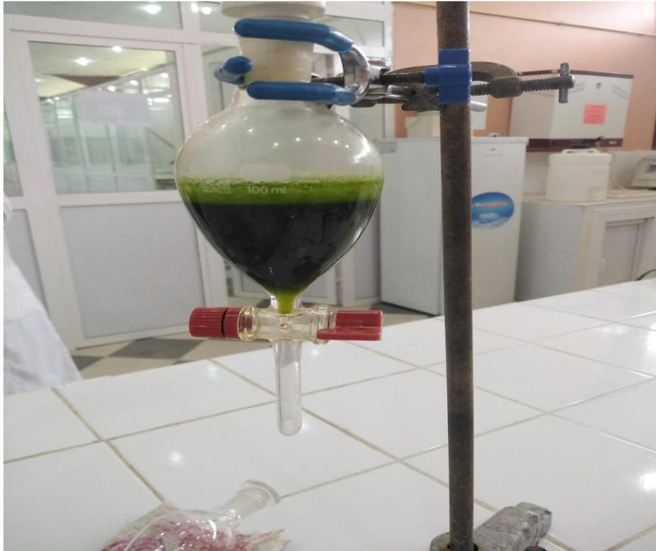
**Figure 12 :** Extraction liquide- liquide en utilisant l'ampoule à Décanté (Originale, 2020).
