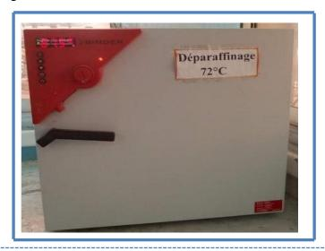
Figure 24 : Etuve utilisée pour le déparaffinage (photo originale).
