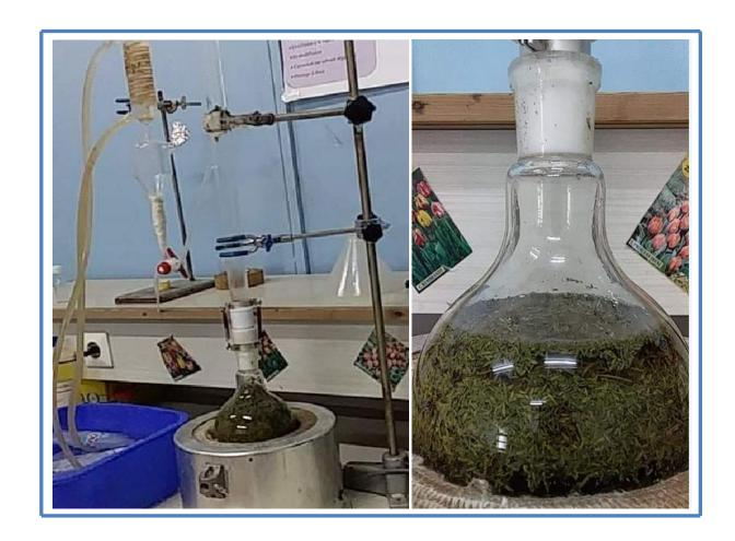
Figure 26 : Clevenger utilisé pour l'hydrodistilation d'huile de thym (photos originales).
