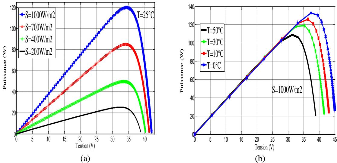
Figure 1.14. Les caractéristiques P-V d'un module PV (BP-MSX-120), (a): en fonction de différents éclairements à  $T=25^{\circ}\text{C}$ , (b) : en fonction de différentes températures à  $S=1000\text{W}/\text{m}^2$
