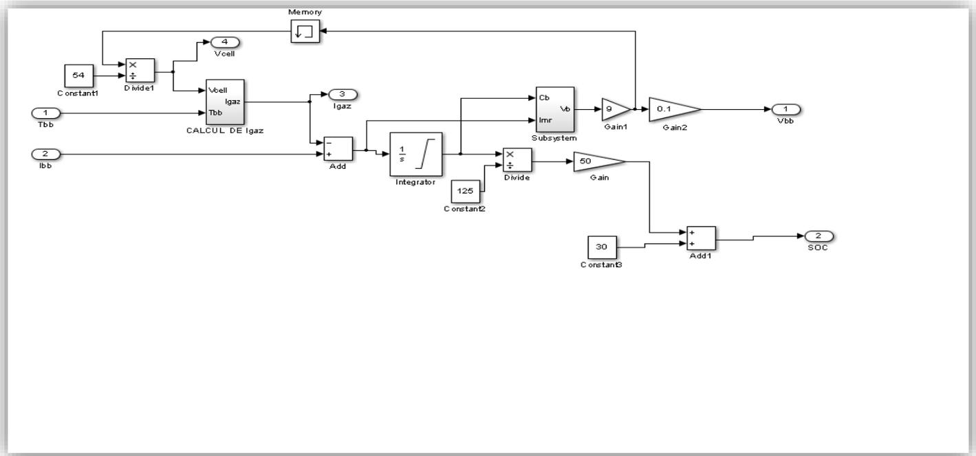
**Module de Batterie sur Simulink**
