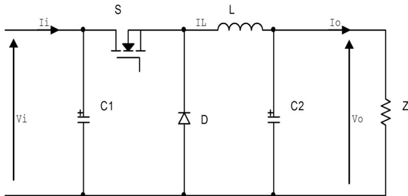
Figure.II.2 : Circuit électrique du convertisseur Buck
