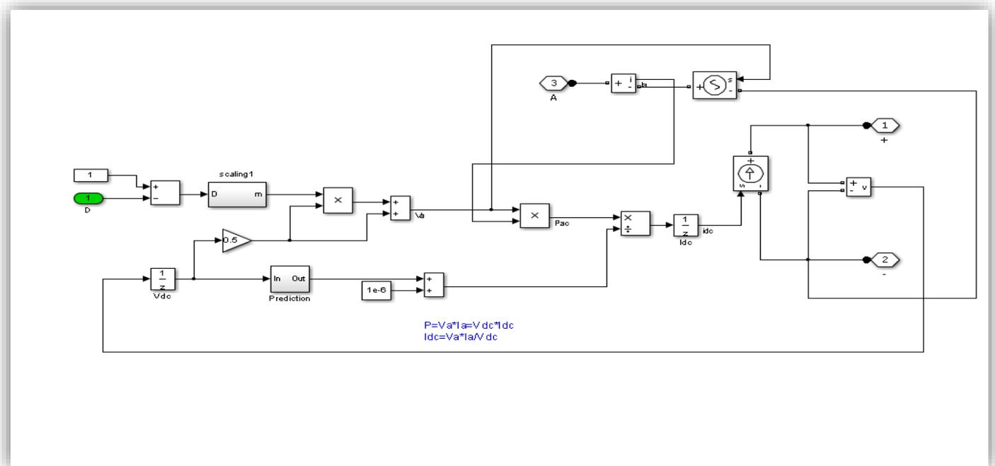
**Module de convertisseur Boost sur Simulink**
