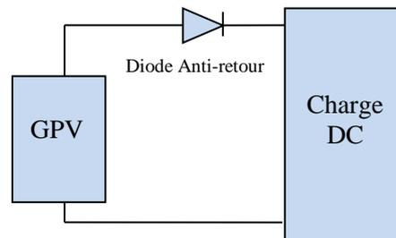
Figure 1.22. Connexion directe GPV-Charge via une diode anti-retour.
