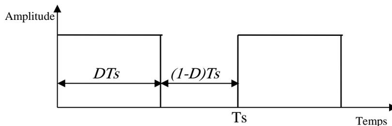
Figure 1.16. Tension PWM pour la commande du commutateur
