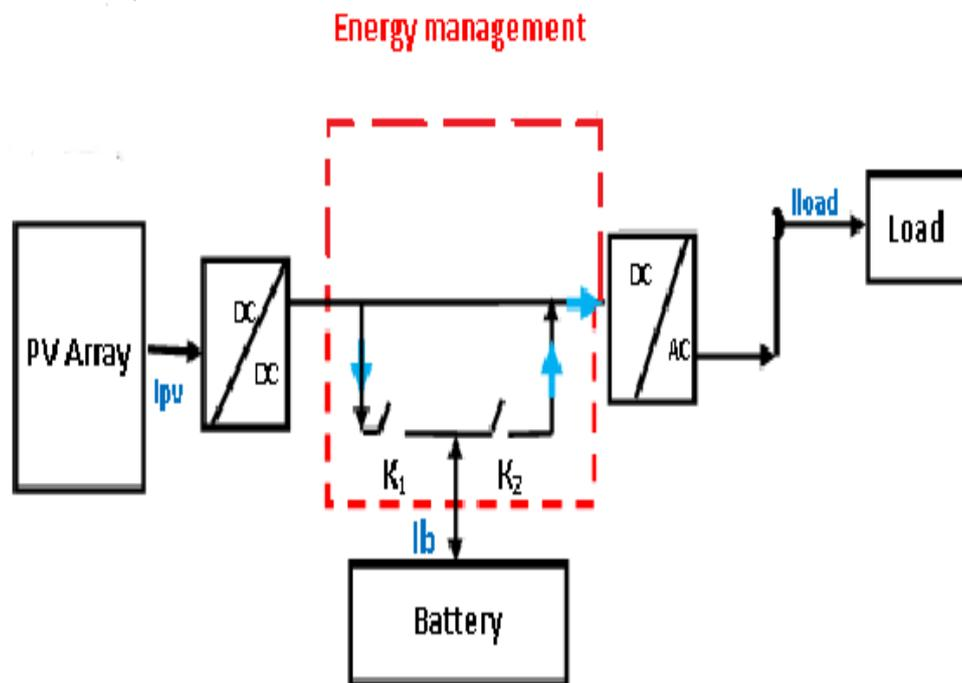
Figure III.1 : système PV autonome étudié
