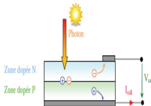
Figure 1.12. Schéma de principe de la conversion photoélectrique [24]
