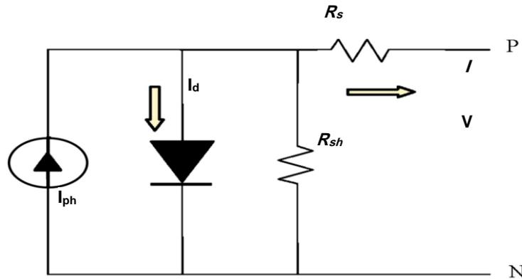
Figure II. 1. Le circuit électrique équivalent du modèle utilisé
