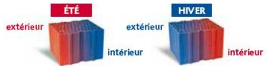
Le mono-mur et les ponts thermiques :
