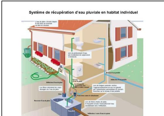
**Figure 19 :** Système de récupération des eaux de pluie intégré en habitat domestique. **Source :** <http://recuperation-eau-de-pluie.durable.com/>
