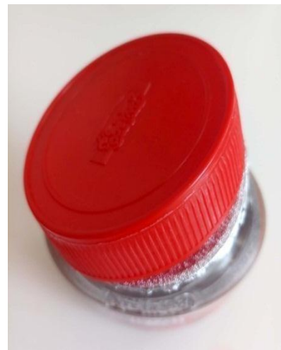
Figure 3 : couvercle en PEHD utilisé
