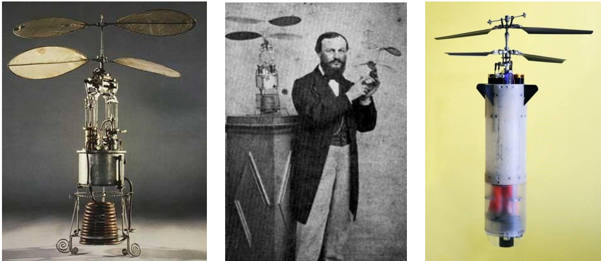
Figure 1.1 : Le premier hélicoptère coaxial à vapeur
