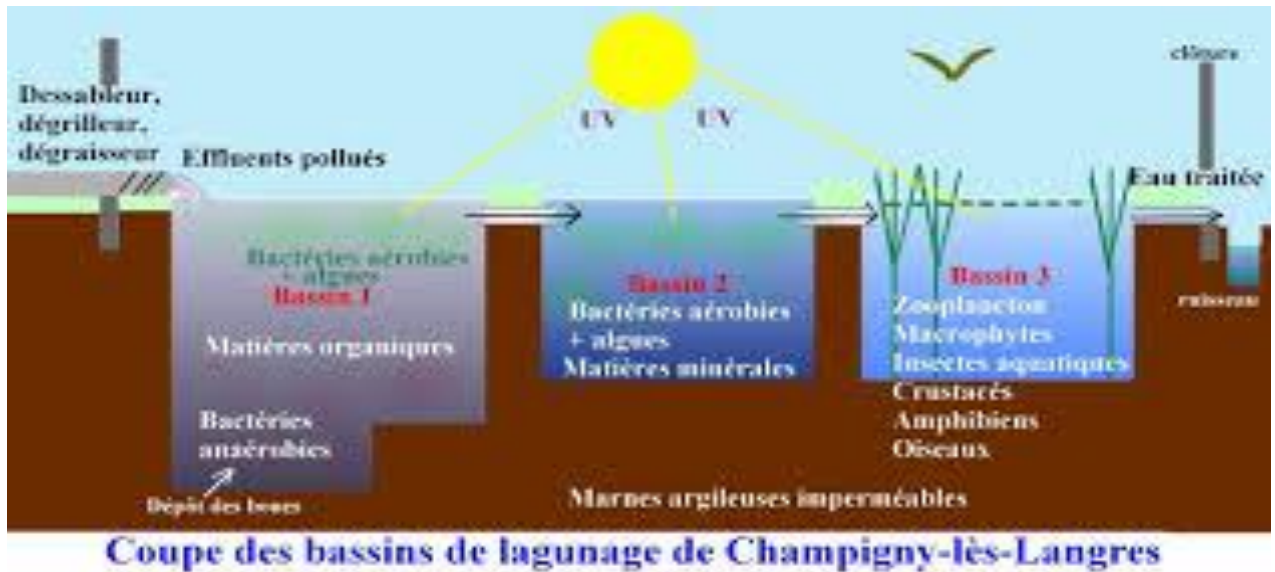
Figure 7 : Schéma représentatif de l'opération de lagunage
