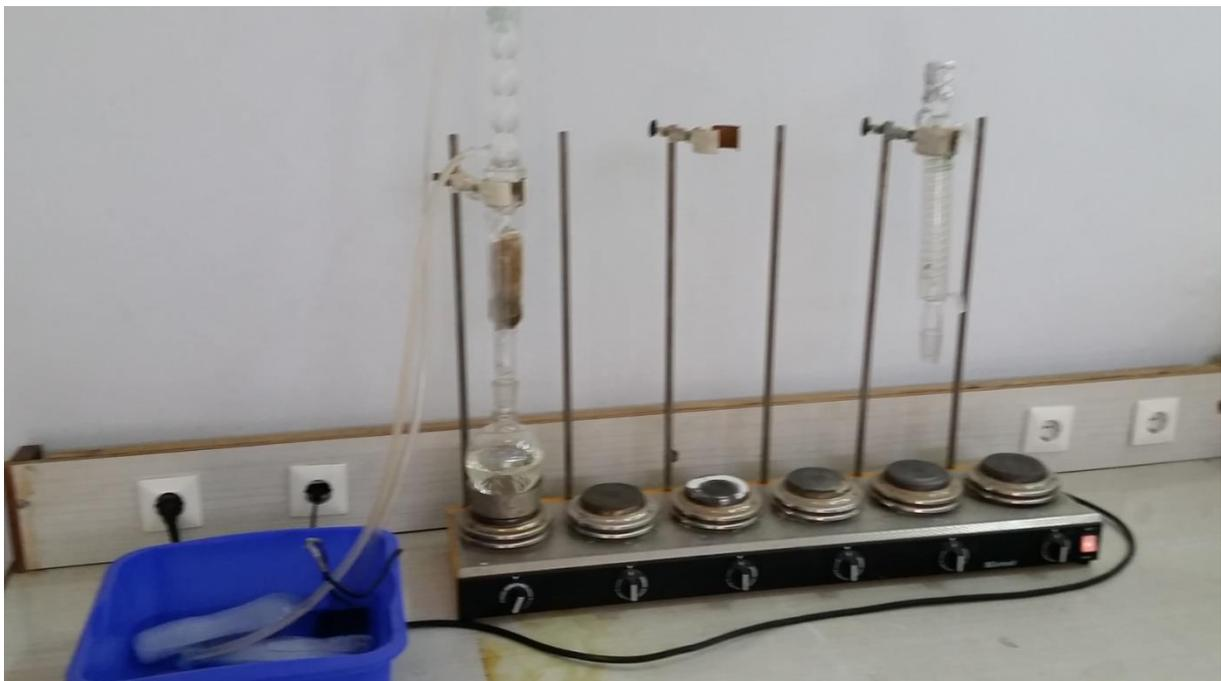
**Figure (12) : Appareil de Soxhlet (Photo d'originale).**
