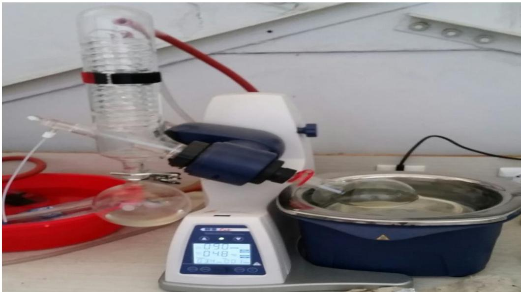
**Figure (13) : Evaporateur « Rota- vapeur » (Photo originale).**
