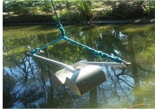
Figure 3 : Benne avec mâchoire ouverte et fermée.
