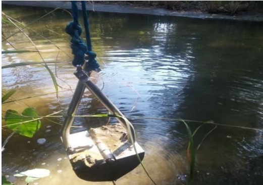
Figure 3 : Benne avec mâchoire ouverte et fermée.
