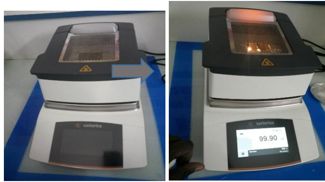
Figure 8 : la méthode de détermination de l'extrait sec total par la méthode de thermobalance
